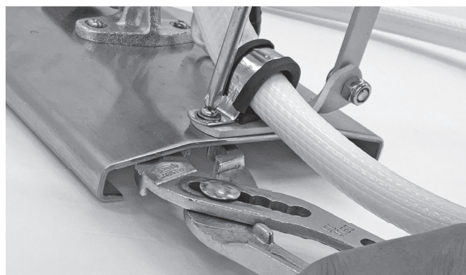
スタンドから取り外したネジとナットで、 センサーとホースを固定します。
