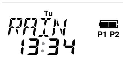
スイッチをセンサー作動にして、降雨がありセンサーが働いている場合は現在時刻と、「RAIN」表示され、自動散水は行われません。手動運転は可能です。
