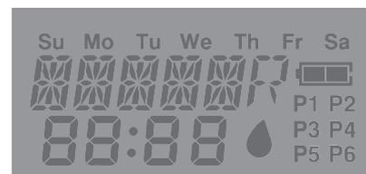
液晶は通電感知をして文字を表示させますが、全体の温度が上がり過ぎてしまった場合には全体が液漏れしたように黒くなる場合があります。
