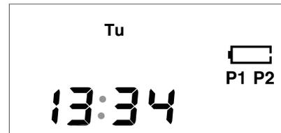
電池が消耗すると電池のマークの残量表示が、無くなり散水出来なくなくなります。操作盤部品を陽のあたる所に置いて、充電して下さい。
